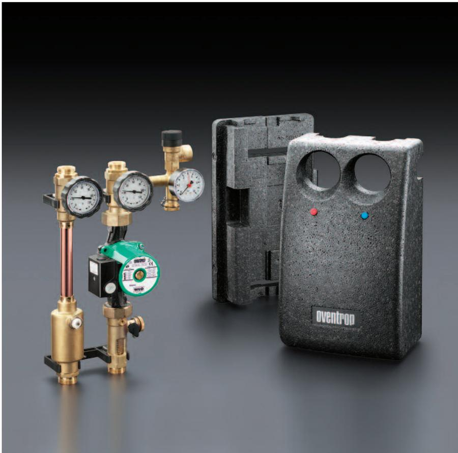
**1** "Regusol L-180" DN 25 gruppo solare con gruppo di sicurezza (lungh. circolatore 180 mm) e ulteriore disareatore per degasare il fluido termovettore nella colonna di mandata, per il diretto collegamento al circuito solare DN 25 con raccordi di serraggio "Regusol".
