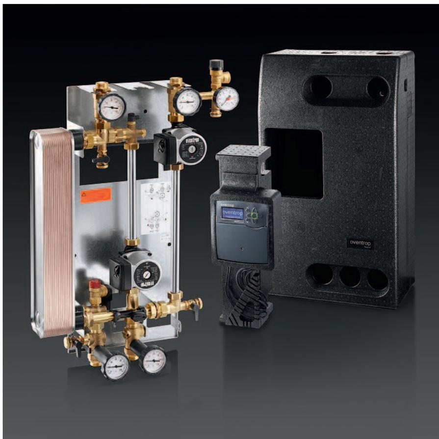
Gruppo valvole con centralina elettronica, con scambiatore di calore per il trasferimento controllato dell'energia termica del circuito solare (circuito primario) ad un serbatoio monovalente (secondario); ad esempio per un serbatoio esistente senza il collegamento solare diretto.
