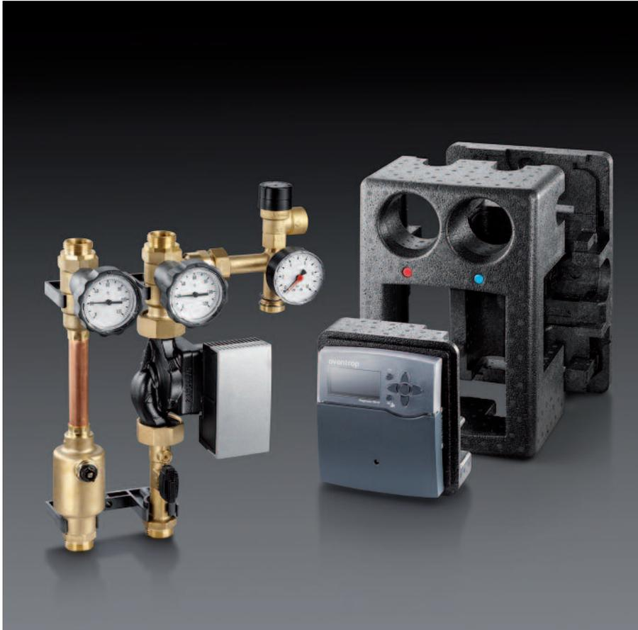
**1** "Regusol ELH-130-B" gruppo solare con gruppo di sicurezza (lungh. circolatore 130 mm) con centralina elettronica "Regtronic RC-B" e disaeratore per degassare il fluido termovettore nella colonna di mandata. Collegamento al circuito solare DN 25 con raccordi di serraggio "Regusol". Completamente premontato e sottoposto alla prova di tenuta stagna, con gruppo di sicurezza e dispositivo per montare un vaso d'espansione.
