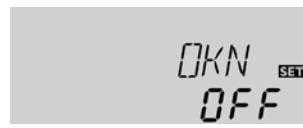
Wenn die Kollektorminimalbegrenzung aktiviert ist, schaltet der Regler die Pumpe (R1) nur ein, wenn die einstellbare Kollektorminimaltemperatur überschritten ist. Die Kollektorminimalbegrenzung verhindert, dass die Pumpe bei sehr niedrigen Kollektortemperaturen zu oft eingeschaltet wird. Für diese Funktion ist eine Hysteresis von 5 °K [10 °Ra] festgelegt.
