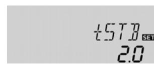
Le paramètre **tSTB** permet de définir la durée pendant laquelle la condition de désactivation (DT F) n'est plus prise en considération à la fin du remplissage du système.
