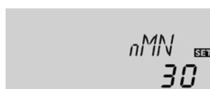
Mit dem Einstellkanal **nMN** kann dem Ausgang R1 kann eine relative Minimaldrehzahl zugewiesen werden.
