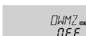
Wird OWMZ aktiviert, kann die gewonnene Wärmemenge errechnet und angezeigt werden. Eine Wärmemengenbilanzierung ist in Verbindung mit einem Flowmeter möglich. Um eine Wärmemengenbilanzierung zu ermöglichen, folgendermaßen vorgehen:
