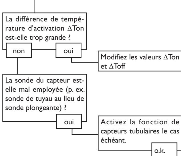
La différence de température entre le réservoir et le capteur augmente beaucoup lorsque le système est activé; le circuit du capteur n'arrive pas à évacuer la chaleur.
