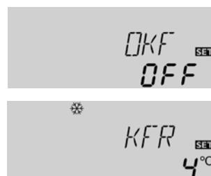
Die Frostschutzfunktion aktiviert den Ladekreis zwischen Kollektor und Speicher, wenn die Temperatur unter die eingestellte Frostschutztemperatur fällt. So wird das Wärmeträgermedium gegen Einfrieren und Eindicken geschützt. Wird die eingestellte Frostschutztemperatur um 1 K [2 °Ra] überschritten, deaktiviert der Regler den Ladekreis.
