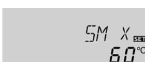
Wird die eingestellte Speichermaximaltemperatur am unteren Speichersensor überschritten, schaltet der Regler die Solarpumpe ab. Eine weitere Beladung des Speichers wird unterbunden, um das Risiko für Verbrühungen und Anlagenschäden zu senken. Eine Hysteresis von 2 K [4 °Ra] ist für die Speichermaximaltemperatur festgelegt.
