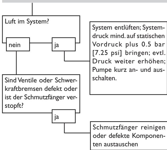
Pumpe läuft kurz an, schaltet ab, schaltet wieder an usw. („Reglerflattern“)
