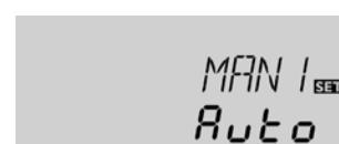
Pour effectuer des opérations de contrôle ou de maintenance, réglez manuellement le mode du relais. Pour cela, sélectionnez le canal de réglage MAN. Vous pourrez alors effectuer manuellement les réglages suivants:
