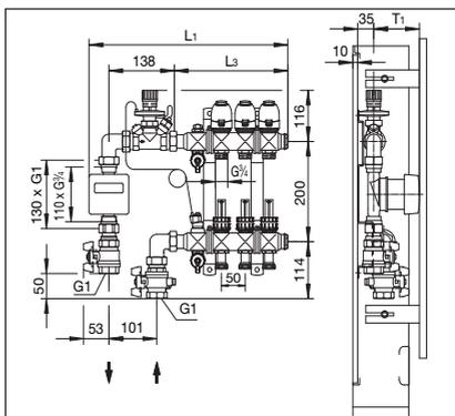
**Illustr. 4:** Exemple: Jeu de raccordement no. 2 pour compteurs de calories, modèle équerre et distributeur/collecteur en acier inoxydable «Multidis SF» pour installations de surfaces chauffantes, longueurs et profondeur
