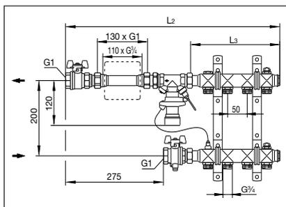
**Abb. 5:** Wärmemengenzähler-Anschluss-Set 2, Durchgangsform und „Multidis SH“ Edelstahl-Verteiler für Heizkörperanbindung, Baulängen
