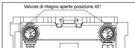
Fig. 39 Valvole di ritegno aperte
