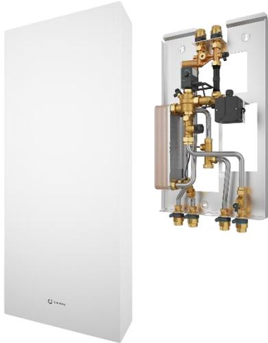
Pour l'approvisionnement d'appartements individuels en eau de chauffage et eau chaude sanitaire. La chaleur de chauffage nécessaire est fournie par une distribution de chaleur centrale. L'eau potable est chauffée de manière décentralisée via un échangeur de chaleur à plaques en circulation continue. La qualité d'eau dans la région d'utilisation doit être prise en compte lors du choix de la station d'appartement.
