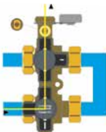
Golirea instalației/ consumatorului, aerisirea și spălarea instalației
