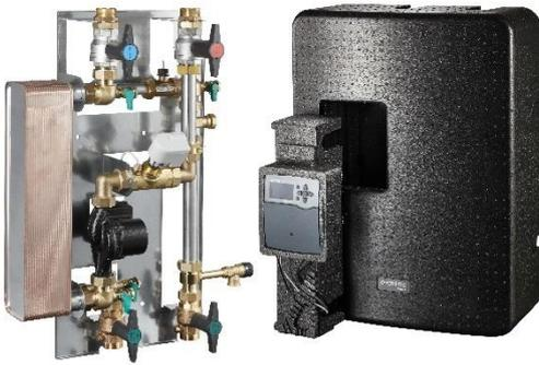
La station d'eau chaude sanitaire Regumaq X-70 est un groupe de robinetterie à réglage électronique avec échangeur de chaleur pour la préparation instantanée d'eau chaude sanitaire pour le raccordement à un ballon tampon. La vitesse du circulateur côté chauffage est réglée en fonction de la température et du débit côté E.C.S. La qualité d'eau dans la région d'utilisation doit être prise en compte lors du choix de la station d'eau chaude sanitaire.
