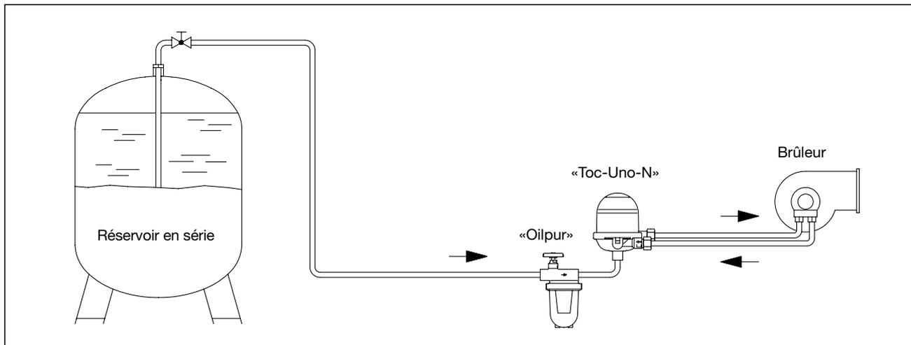
Installation du séparateur d'air au-dessus du niveau de mazout, par ex. réservoir enterré
