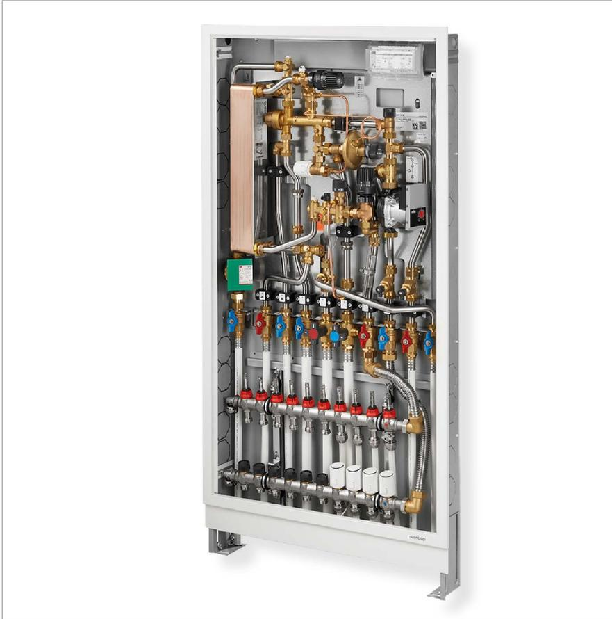
Die Station „Regudis W-HTF“ ist eine komplett auf einem Halterungsblech montierte und dichtgeprüfte Einheit mit direktem oder gemischtem Heizkreis. Die Station dient zur Versorgung einer Wohnung mit Heizwasser für die Flächenheizung und Radiatoren sowie mit kaltem und warmem Trinkwasser.
