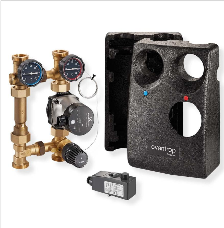
Das Festwertregel-Set „Regumat F/FR-130/180“ dient der Vorlauftemperaturregelung und -begrenzung in kombinierten Radiator-Flächenheizungen. Die Vorlauftemperatur wird in einem Einstellbereich von 20–50 °C geregelt. Die Ausführung „Regumat FR-180“ besitzt ein Pumpengehäuse aus Edelstahl/Rotguss, um der Korrosionsgefahr bei systembedingtem Sauerstoffeintrag entgegenzuwirken.
