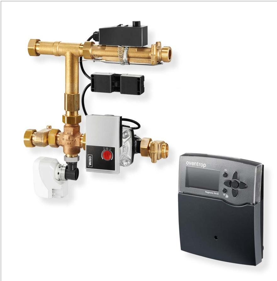
1 Die „Regufloor HW“ Regelstation wird in Zentralheizungsanlagen eingesetzt um die Vorlauftemperaturen für Flächenheizungen zu regeln. Die Regelung der Vorlauftemperatur erfolgt dabei witterungsabhängig, d.h. in Abhängigkeit von der Außentemperatur, bis zu einem einstellbaren Maximalwert. So kann die maximal zulässige Vorlauftemperatur (z.B. 45 °C) für die Flächenheizung eingehalten werden.
