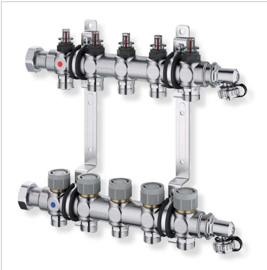
**1** „Multidis SFQ“ Edelstahl-Verteiler für Flächenheizung- und kühlung mit integrierten Durchflussindikatoren im Vorlauf mit Q-Tech“ für den automatischen Hydraulischen Abgleich.
