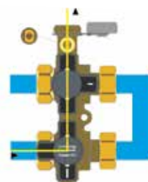
Aftappen van de installatie of het toestel, ontluichten en spoelen van de installatie
