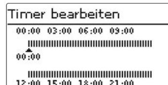
Die Zeitfenster können in Schritten von je 15 Minuten eingestellt werden. Mit den Tasten **2** und **4** kann der Cursor auf der Zeitschiene bewegt werden.
