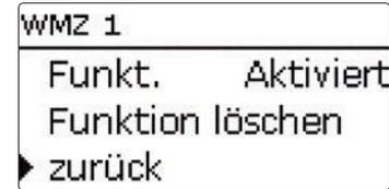
Um den Wärmemengenzähler zu deaktivieren, unten im Menü die Zeile **Funktion löschen** anwählen.
