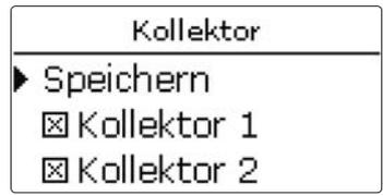
Wenn aus verschiedenen Auswahlmöglichkeiten mehrere gleichzeitig gewählt werden können, werden sie mit Checkboxes angezeigt. Wenn ein Punkt angewählt wird, erscheint ein x innerhalb der Checkbox.
