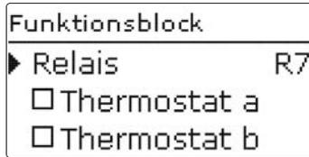
Zusätzlich zu den vordefinierten Wahlfunktionen stehen Funktionsblöcke zur Verfügung, die sich aus Thermostat-, Timer- und Differenzfunktionen zusammensetzen. Mit ihnen lassen sich weitere Komponenten bzw. Funktionen realisieren.
