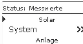
Im Menü Status/Mess-/Bilanzwerte werden alle aktuellen Messwerte sowie verschiedene Bilanzwerte angezeigt. Einige der Anzeigezeilen können ausgewählt werden, um in ein Untermenü zu gelangen.
