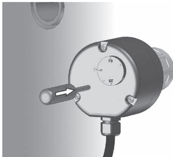
Figure 17: Déblocage à l'aide d'un tournevis
