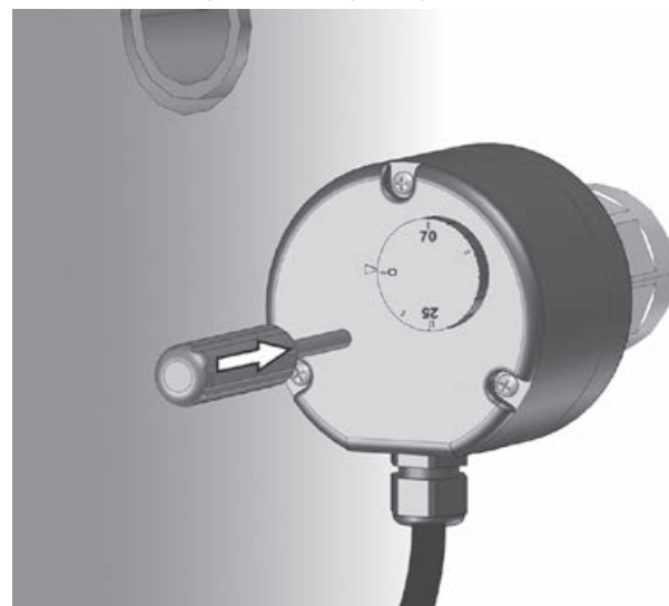
Abbildung 17: Entriegelung mit Schraubenzieher
