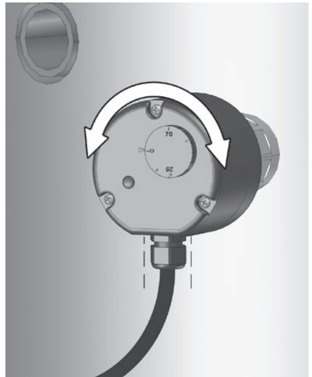
Figure 13: Aligner le presse-étoupe de câble
