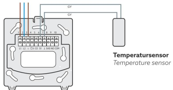
Der ClimaCon F Temperatursensor dient als externer Temperatursensor zur Aufnahme der Temperatur im Raum oder zur Erfassung der Flächentemperatur als Limiter.
