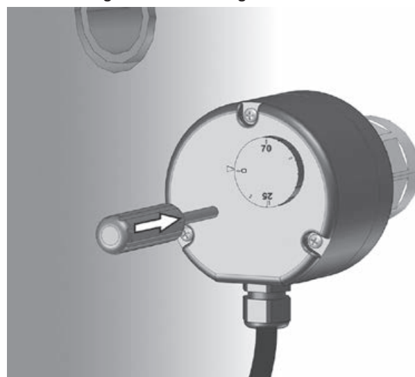
Figure 17: Déblocage à l'aide d'un tournevis
