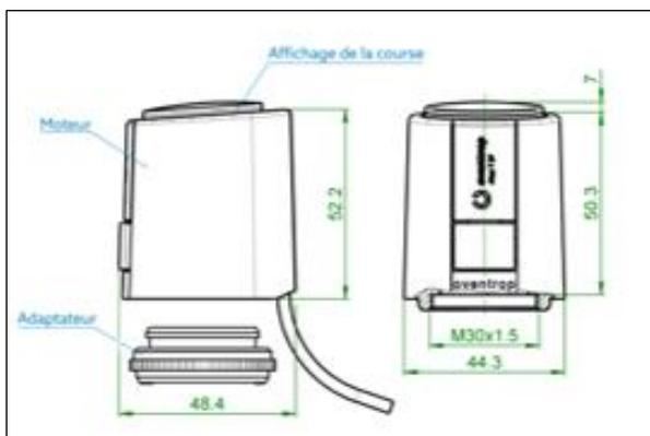
Encombresments moteur avec raccordement fileté M 30 x 1,5
