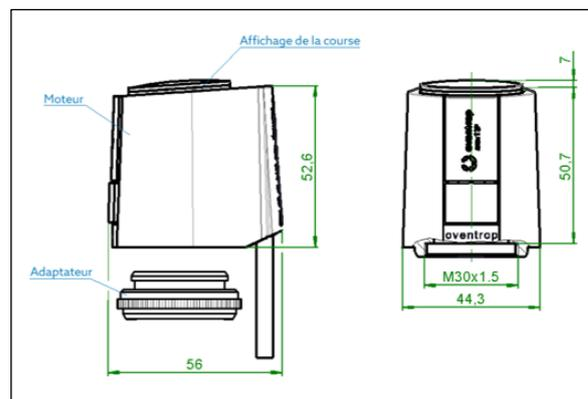
Encombresments moteur avec interrupteur auxiliaire
