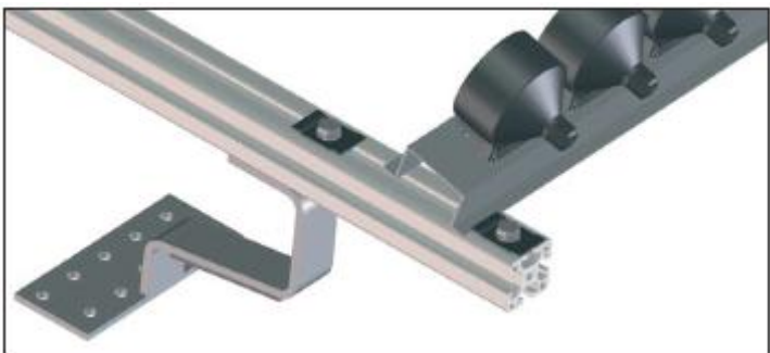
Illustr. 11: posizionare la guida al piede nella guida di montaggio
