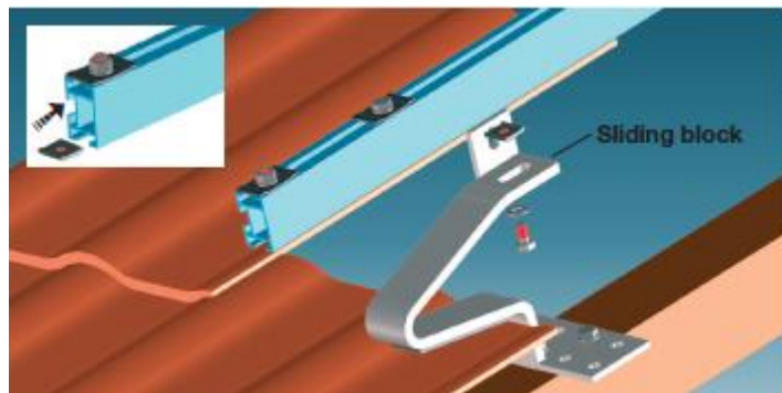
Illustr. 7: Fissaggio delle guide di montaggio
