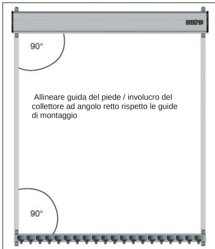
Illustr. 17: Collettore a tubi (illustr. OKP 20) senza tubi sottovuoto.
