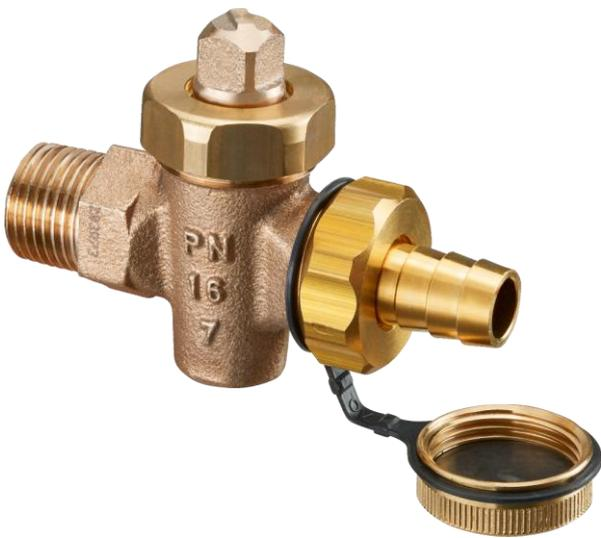
In Anlehnung an DIN 3848. Für Flüssigkeiten, Dampf und aufbereitete Heizwasser, z.B. Fernheizung. Kurzzeitig bis 180 °C einsetzbar. Die Auf-/Zustellung des KFE Kükenhahns wird mit einer 90° Drehbewegung erreicht. Die Schaltstellung ist auf der Oberseite des Vierkants markiert.
