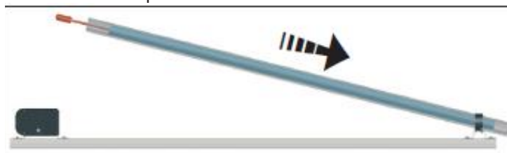
Illustr. 21: spingere il tubo sottovuoto attraverso la staffa per tubo più in basso
