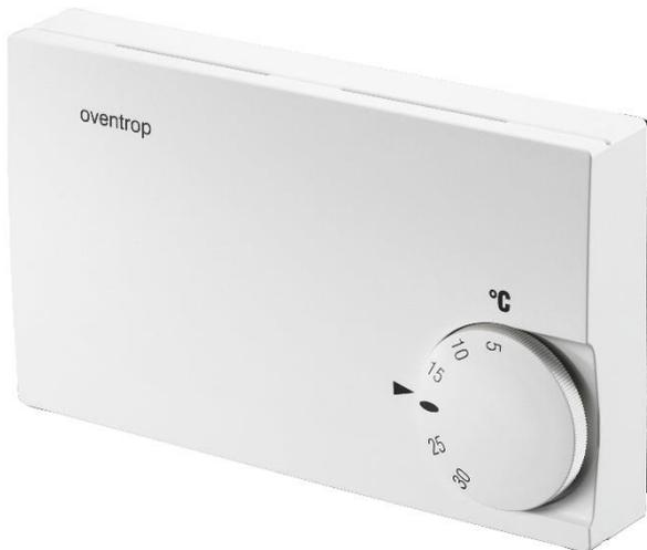
Der Raumthermostat eignet sich für die individuelle Raumtemperaturregelung oder zur Zonenregelung in Vierleitersystemen. Der Raumthermostat kann als System in Wohn- oder Bürogebäuden genutzt werden. Die Raumtemperaturregelung erfolgt auf Basis von zwei Proportionalausgängen, jeweils für Heizen und für Kühlen. Die Umschaltung zwischen den beiden Modi erfolgt auf Basis der Abweichung der Raumtemperatur vom eingestellten Sollwert.
