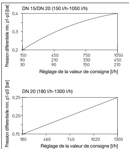
Fig. 5.7 Préssion différentielle min. / Réglage de la valeur de consigne
