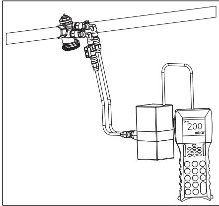
Abb. 5.5 Differenzdruckmessung
