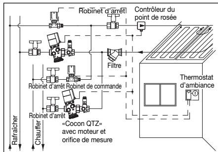
Fig. 6.2 Système à quatre tuyaux
