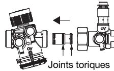
3. Insérer le mécanisme
