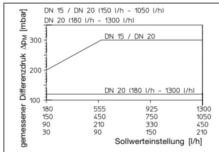
Abb. 5.1 Differenzdruck / Sollwertestellung
