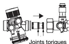
4. Monter le joint et serrer l'écrou de serrage
