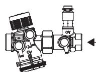
Fig. 6.3 Remplacement du mécanisme à l'orifice de mesure
