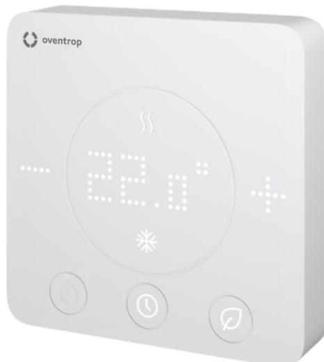
Les thermostats d'ambiance ClimaCon F sont utilisés pour la régulation de la température dans des installations de surfaces chauffantes et rafraîchissantes ainsi que de plafonds chauffants et rafraîchissants dans les maisons individuelles ou les appartements. La température ambiante est réglée par un robinet, qui est commandé par le thermostat d'ambiance via un moteur électrothermique. Lorsque la température ambiante atteint la température de consigne, le robinet se ferme.
