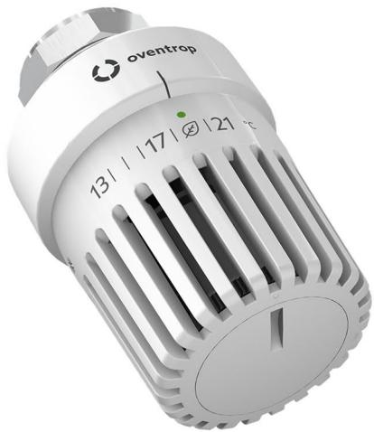
Termostatele și ventilele termostatice Oventrop formează împreună un sistem de reglare proporțională care funcționează fără energie auxiliară. Termostatele și ventilele regleză temperatura din încăpere prin modificarea debitului de agent termic care circulă în radiator.
