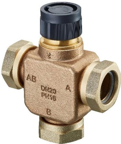
Le Tri CTR est un robinet à trois voies qui peut être utilisé comme robinet inverseur ou mitigeur. Pour être utilisé comme robinet inverseur, le Tri-CTR a une entrée (AB) et deux sorties (A et B). En fonction de la position du clapet, le fluide circulant est dévié vers l'une ou l'autre sortie du robinet.
