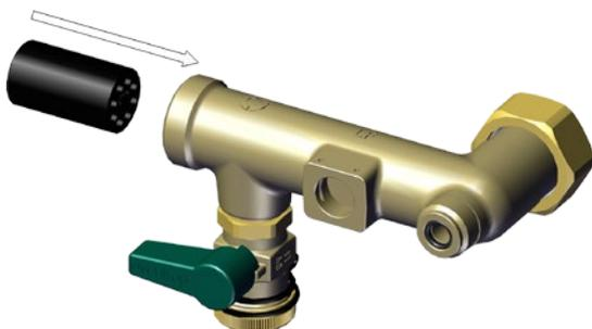
Fig. 35: Instalar la turbina de medición
