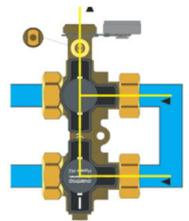
Fermeture et vidange du côté appareil
