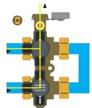
Remplissage et purge du côté installation
