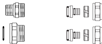
Tehnica de racordare „Cofit S“ pentru racord cu filet interior și exterior
