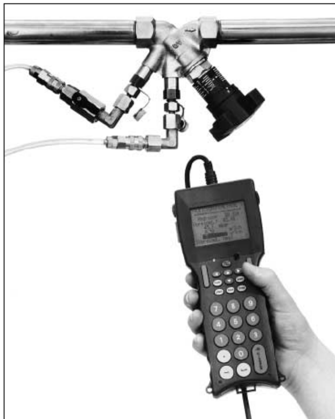
Calculatoare de măsurare a presiunii diferențiale, „OV-DMC 2“, nr. art. 106 91 77 cu „Hydrocontrol R“
