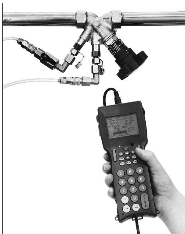
Strumento di misurazione della pressione differenziale „OV-DMC 2“ Cod. art. 106 91 77 con „Hydrocontrol VTR“
