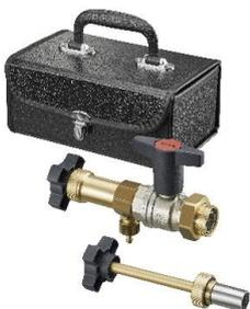
Spezialwerkzeug um Ventileinsätze unter Anlagendruck zu tauschen. Gewindeanschluss M30 x 1,5. Inklusive Kupplungssatz für AQH Ventileinsätze.
