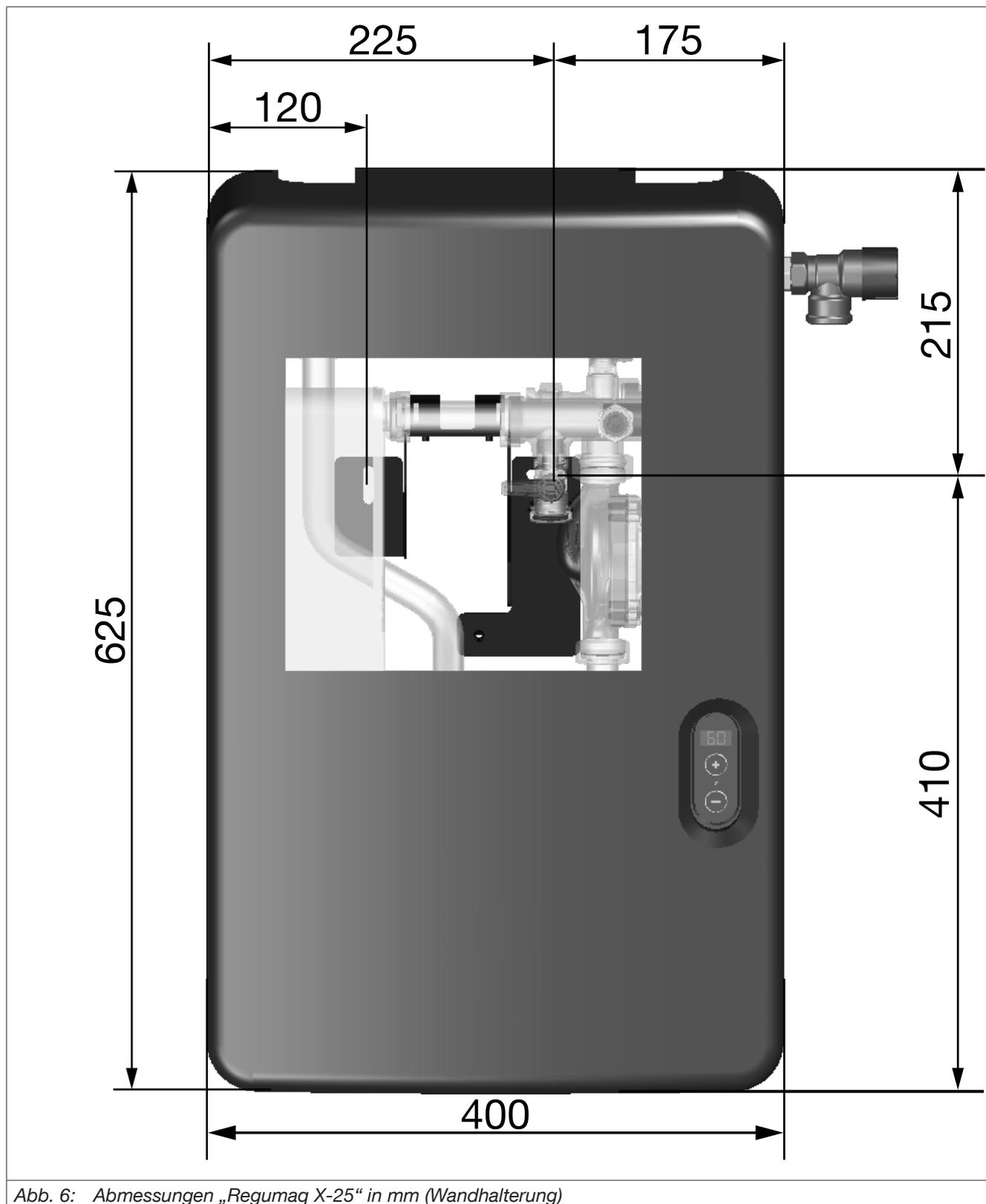
Abb. 6: Abmessungen „Regumaq X-25“ in mm (Wandhalterung)
