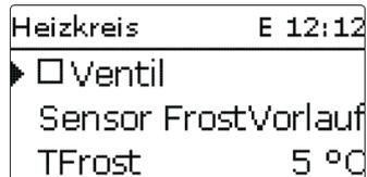
Mit der Option **Ventil** kann ein Relais zugewiesen werden, das parallel zum Heizkreis einschaltet (freie Relais oder Gemeinsame Relais/Ventil 1,2).
