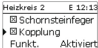
Die Schornsteinfegerfunktion ist in allen Heizkreisen werksseitig aktiviert. Der Schornsteinfegermodus kann aktiviert werden, indem Taste **6** für 5 s gedrückt wird.
