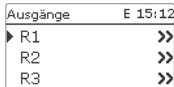
Unter diesem Menüpunkt kann für jedes Relais des Reglers und der externen Module die Steuerungsart und die Minimaldrehzahl eingestellt werden.
