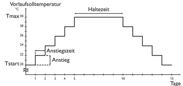
Das Diagramm zeigt die Parameter der Estrich-Trocknung mit den Werkseinstellungen.
