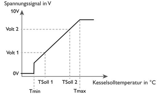
Mit den Einstellkanälen **Tmax** und **Tmin** können die Maximal- und Minimaltemperaturen für die Kesselsolltemperatur eingestellt werden.
