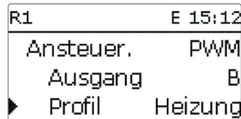
Die Ansteuerung gibt an, auf welche Weise die Drehzahlregelung einer angeschlossenen Pumpe erfolgt. Folgende Modi stehen für die Ansteuerung zur Auswahl:
