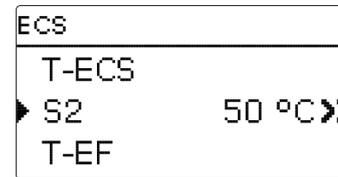
Lorsque, p. ex., ECS est sélectionnée, un sous-menu avec les sondes et relais utilisés dans le système solaire, indique les températures actuelles et la vitesse.
