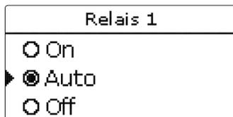
Le mode de fonctionnement des relais peut également être réglé individuellement. Les réglages suivants sont possibles pour tous les relais :
