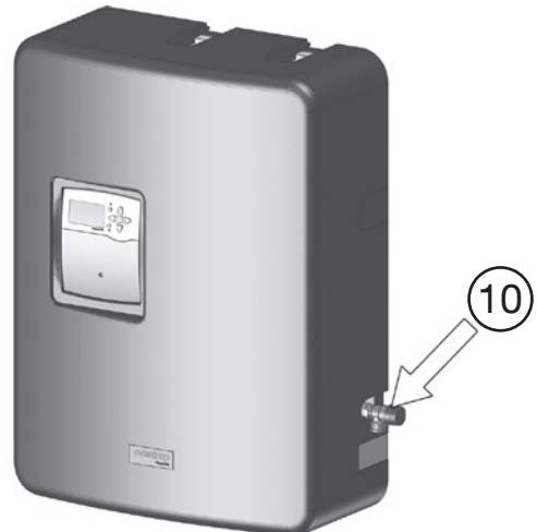
Abb. 6.3: Position Sicherheitsventil Trinkwasser an Station
