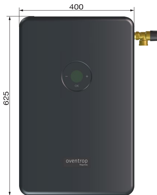
Fig. 5: Encombrenements Regumaq X-45 avec coque supérieure
