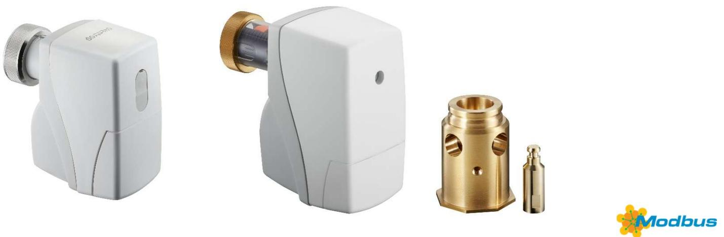
Servo-moteur Modbus pour petites vannes pour le réglage continu dans les installations de chauffage, de ventilation et de rafraîchissement. La commande se fait par communication Modbus RTU. Outre la communication sur le Modbus, deux entrées universelles (binaire et analogique) sont disponibles. L'une des entrées peut être utilisée comme sortie analogique. Les entrées sont adaptées aux fonctions internes et au traitement ultérieur des données vers la domotique (Modbus maître).
