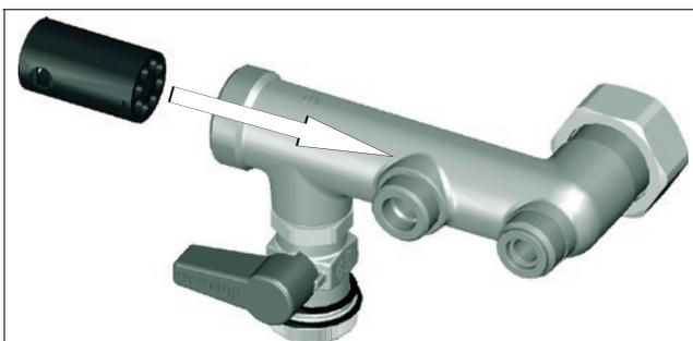
Fig. 37: Instalación de la turbina de medición
