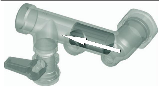
Fig. 36: Extracción de la turbina de medición
