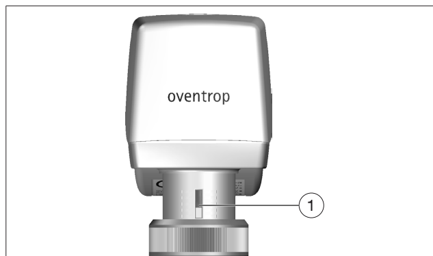
Fig. 7: Affichage de la position de la levée
