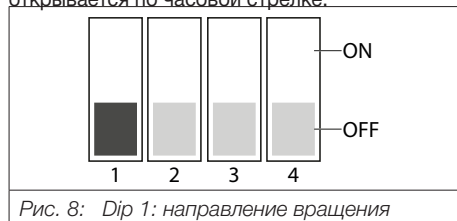
Рис. 8: Dip 1: направление вращения
