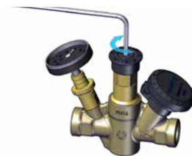
Afb. 8: Instelling richtwaarde temperatuur
