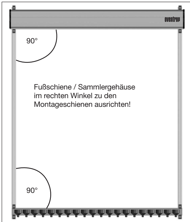
Abb. 17: Röhrenkollektor (Abb. OKP 20) ohne Vakuumröhren
