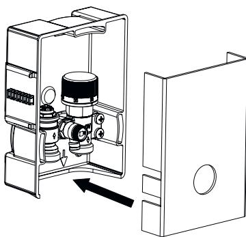
Abb. 11: Bauabdeckung aufsetzen
