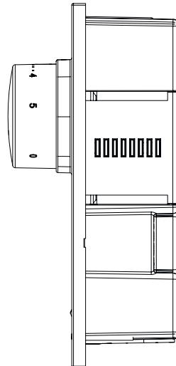
Abb. 5: Abdeckplatte nicht herausgeschoben
