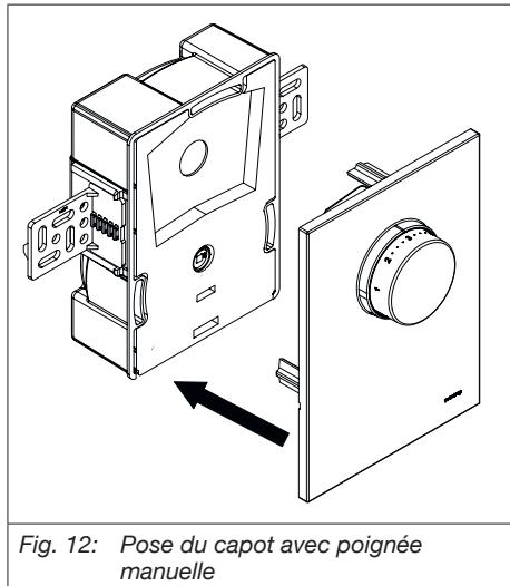
Fig. 12: Pose du capot avec poignée manuelle
