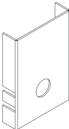
Abb. 1: Bauabdeckung auf „Unibox TQ RTL“
