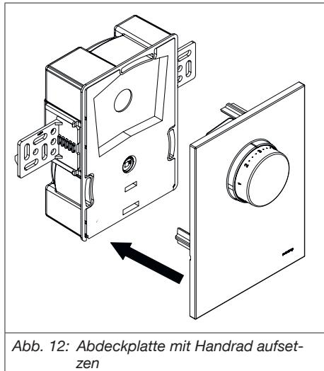
Abb. 12: Abdeckplatte mit Handrad aufsetzen
