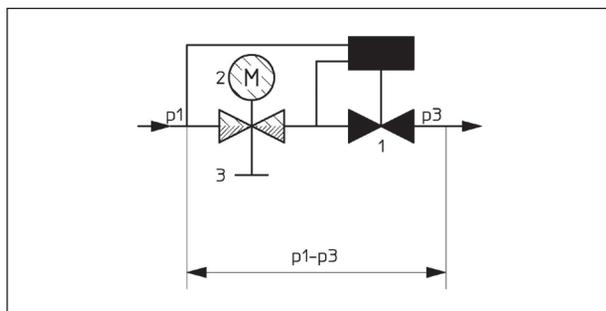
Avec le système de mesure «OV-DMC 3» raccordé, la pression différentielle (p1-p3) à travers le robinet est mesurée au robinet.
