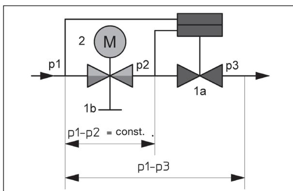
La vue en coupe du robinet de réglage et de régulation combinés «Cocon QTR» montre trois plages de pression. «p1» est la pression d'entrée et «p3» la pression de sortie du robinet. «p2» est la pression agissant dans la membrane.
