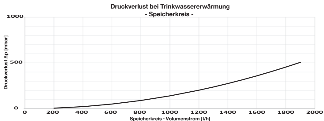
Abb. 40: Kennlinie Druckverlust bei Trinkwassererwärmung (Speicherkreis)
