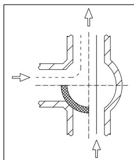
Le mélange est obtenu par la rotation du clapet de la vanne.
