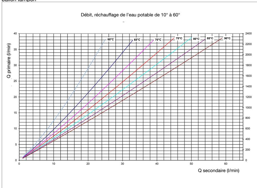
Capacités de puisage (Q secondaire) de la station «Regumaq X-45» en fonction de la température dans le ballon tampon
