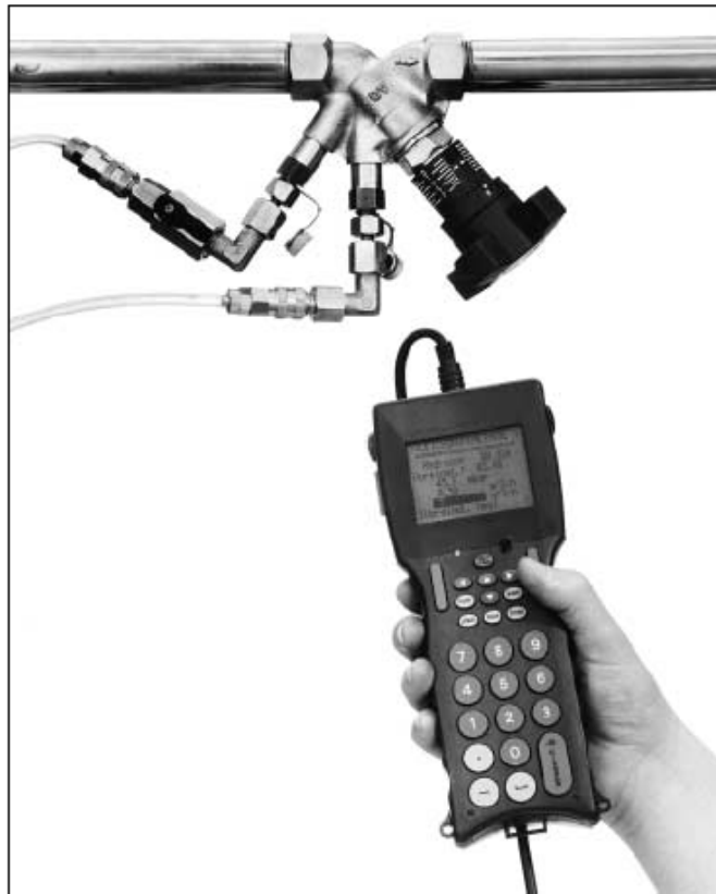
Calculator de măsurare a presiunii diferențiale, „OV-DMC 2”, nr. art. 106 91 77 cu „Hydrocontrol R”
