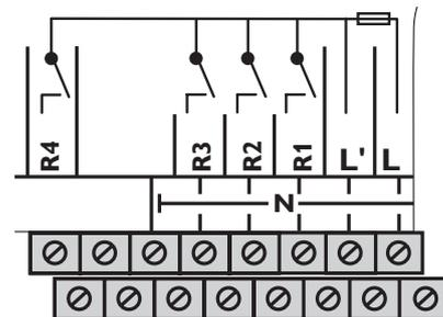
Se suministra electricidad al regulador mediante una línea eléctrica. La alimentación del equipo tiene que ser de 100 ... 240V~ (50 ... 60 Hz).
