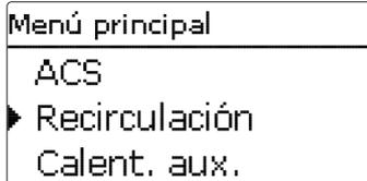
La función **Circulación** se puede utilizar para controlar el funcionamiento de una bomba de recirculación.
