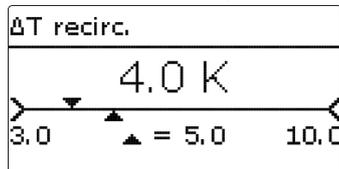
El valor de ajuste **ΔT recirc.** sirve para compensar la pérdida de temperatura en el conducto de recirculación.
