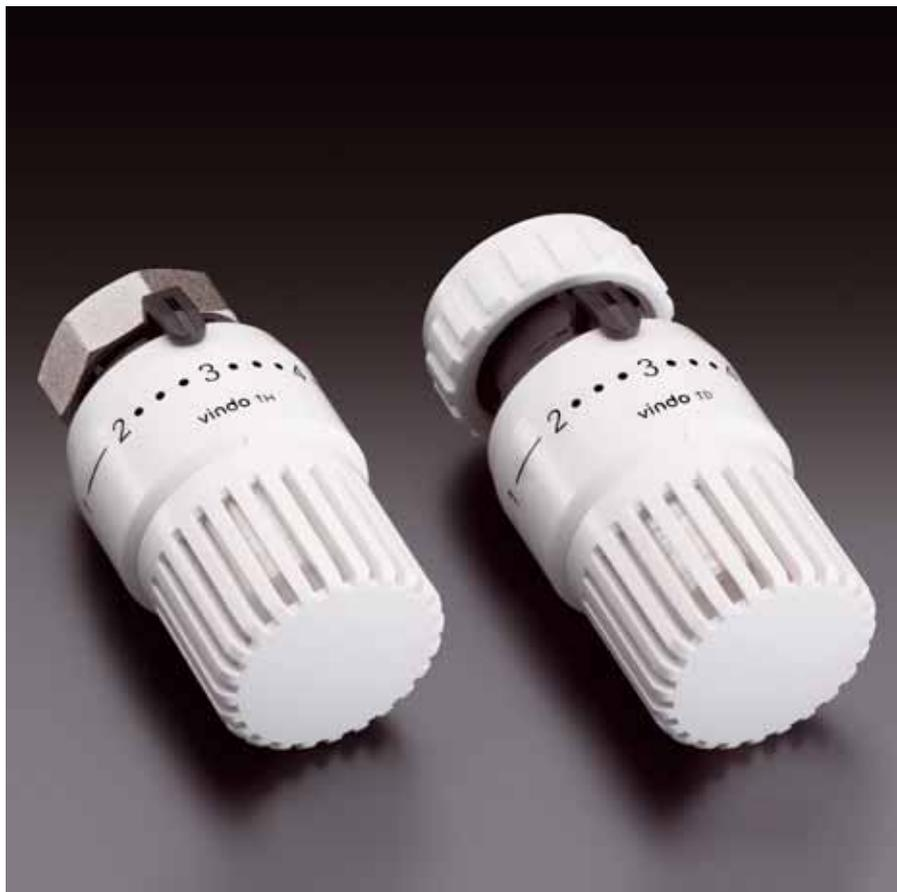
Los termostatos "vindo TH" (conexión roscada M30 x 1.5) y "vindo TD" (conexión a presión) con sensor líquido controlan la temperatura ambiente.
