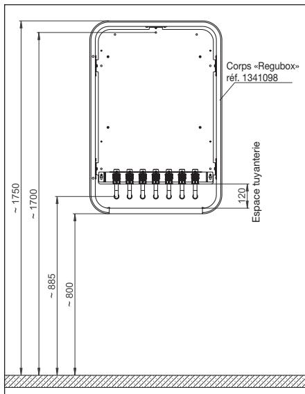
Fig. 4.2 Exemple de montage:
