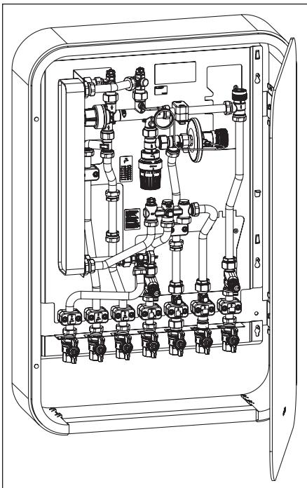
Abb. 4.9 Einbau „Regudis W-HTF“ mit Kugelhahnanschlussleiste
