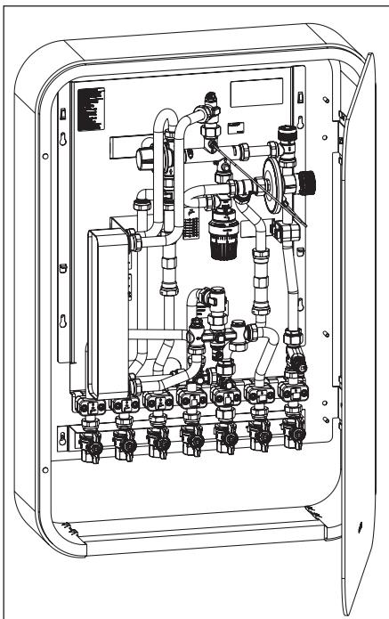
Fig. 4.7 Montage «Regudis W-HTU» avec bloc de raccordement avec robinets à tourant sphérique
