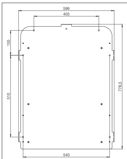
Abb. 4.1 Befestigungspunkte Wandbefestigung
