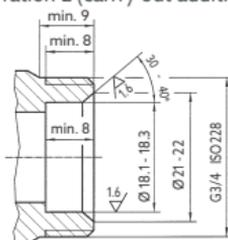
Raccord à serrage à joint souple pour le raccordement de tubes en cuivre selon DIN EN 1057, tubes en acier de précision selon DIN EN 10305- 1/2 et tubes en acier inoxydable à la robinetterie pour radiateurs avec filetage mâle G 3/4 selon DIN EN 16313 (cône «Euro»).
